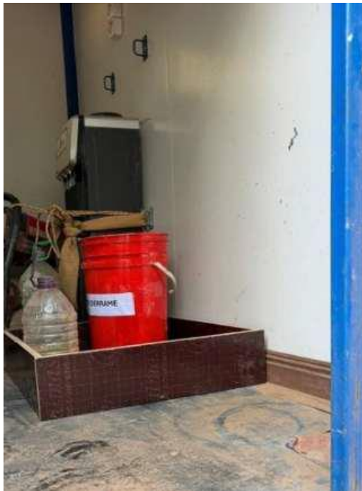
Foto 12.3-7, P04. Cantera de tosca, se incorporó kit para gestión de derrames y bandeja para alojar recipientes con combustibles
