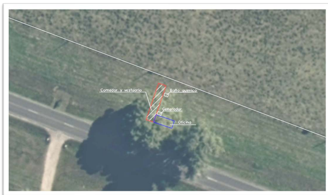
Figura 1 Ubicación y esquema de obrador secundario
